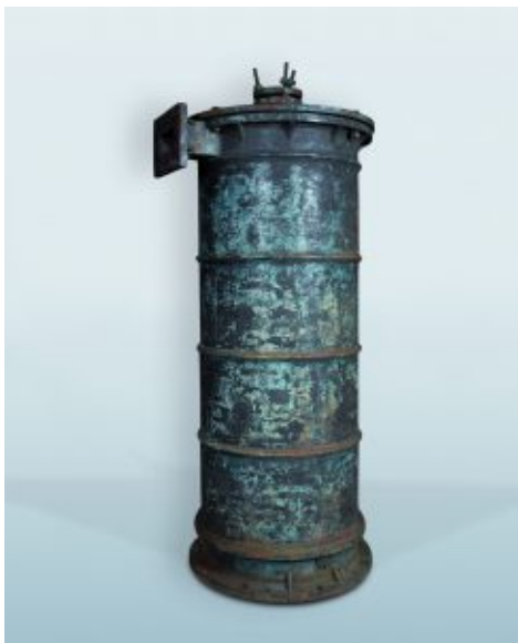
Technikgeschichtliches Zeugnis ersten Ranges: Dampfzylinder der Feuermaschine Saline Königsborn (heute Unna), 1797/99. (© Deutsches Bergbau- Museum Bochum, montan.dok – Foto: Rainer Rothenberg)
