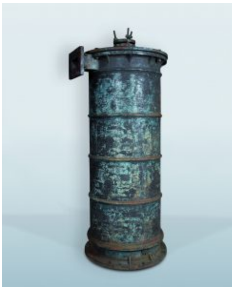
Technikgeschichtliches Zeugnis ersten Ranges: Dampfzylinder der Feuermaschine Saline Königsborn (heute Unna), 1797/99. (© Deutsches Bergbau- Museum Bochum,
