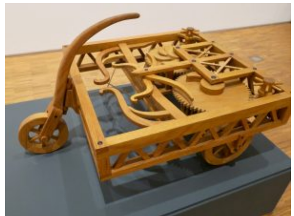
Modellnachbau eines „Automobils“ mit Zahnradgetriebe und Differenzialgetriebe für die Hinterräder – nach einer Leonardo-Skizze von 1493. (Foto: Bernd Berke)
